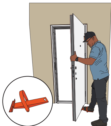
STEP 10. Dørbladet hænges på hængslerne.
